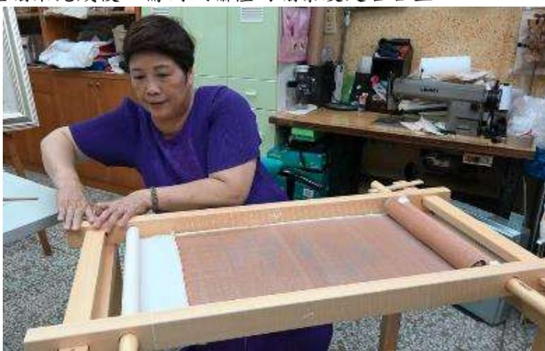
圖 111 測試繡架的鬆緊度
