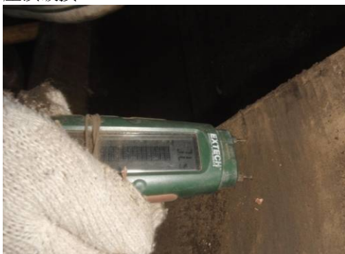
【圖 6-1-9】人字樑因漏水而含水率高
