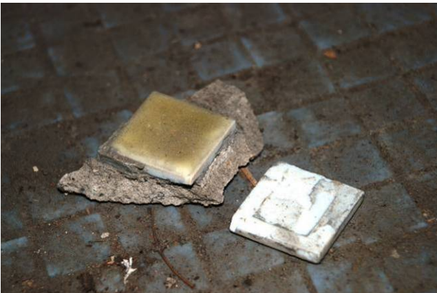
【圖 5-3-91】壁面用馬賽克磁磚的正反兩面
