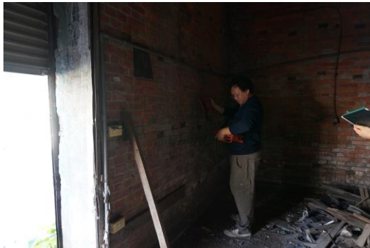
圖 5-5- 1 內牆鋼筋掃描
