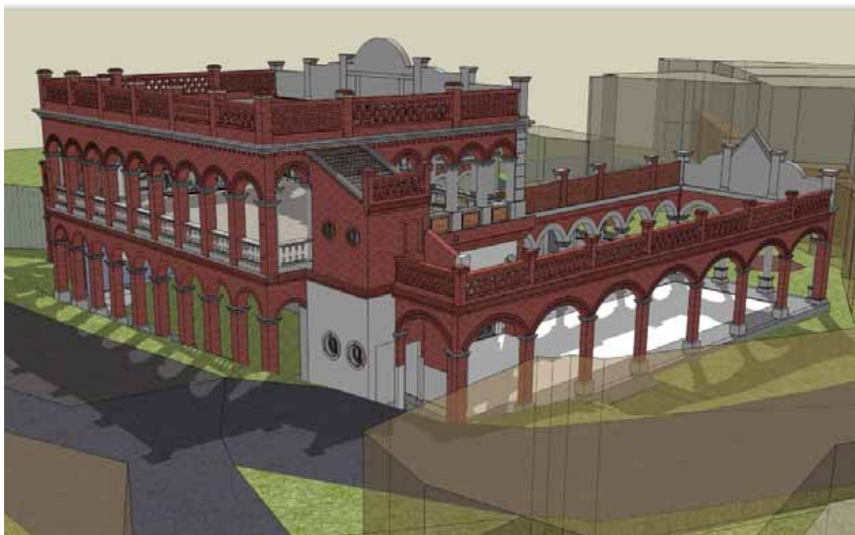
圖5-6 「聚奎居」外廊之結構系統圖-2
