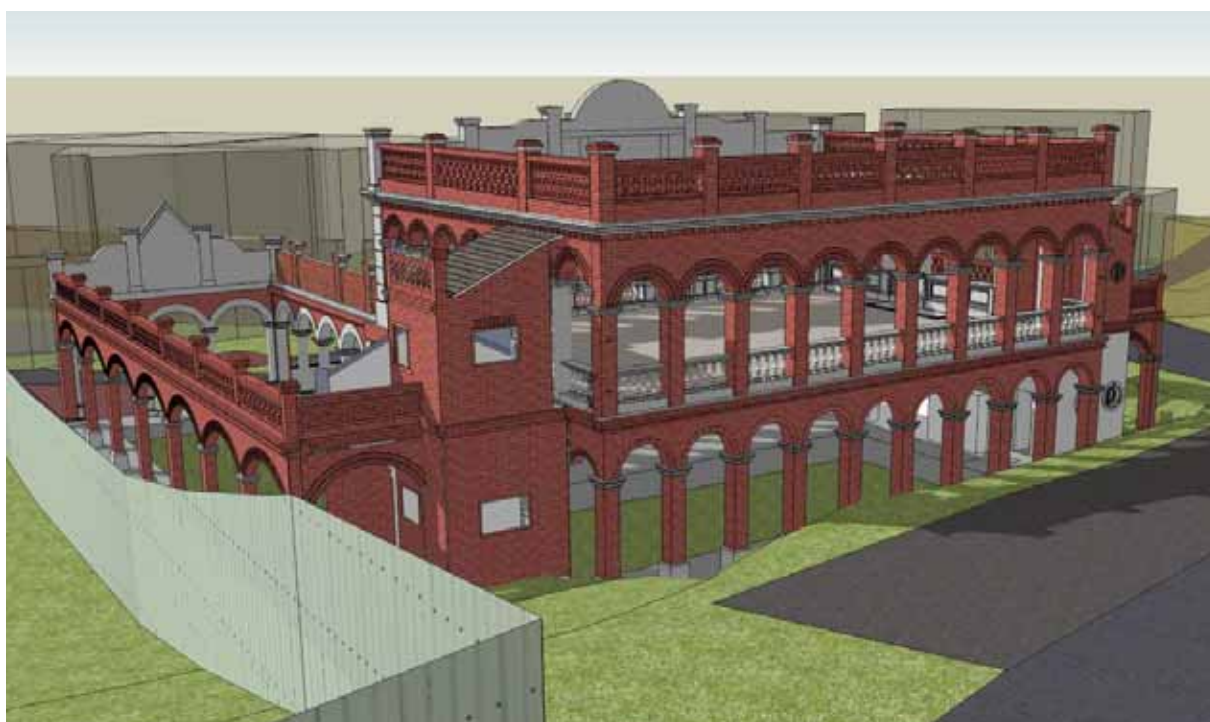
圖5-5 「聚奎居」外廊之結構系統圖-1
